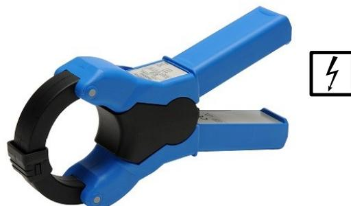
La sonde de courant S a été conçue pour l'utilisation avec des multimètres, des enregistreurs, des analyseurs de puissance et des testeurs de sécurité pour la mesure précise de courants AC sans interruption de circuit.
